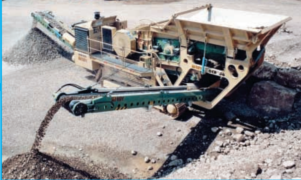
Il gruppo GCR 106 è equipaggiato con un motore John Deere da 6,8 L che sviluppa una potenza di 167 kW.
