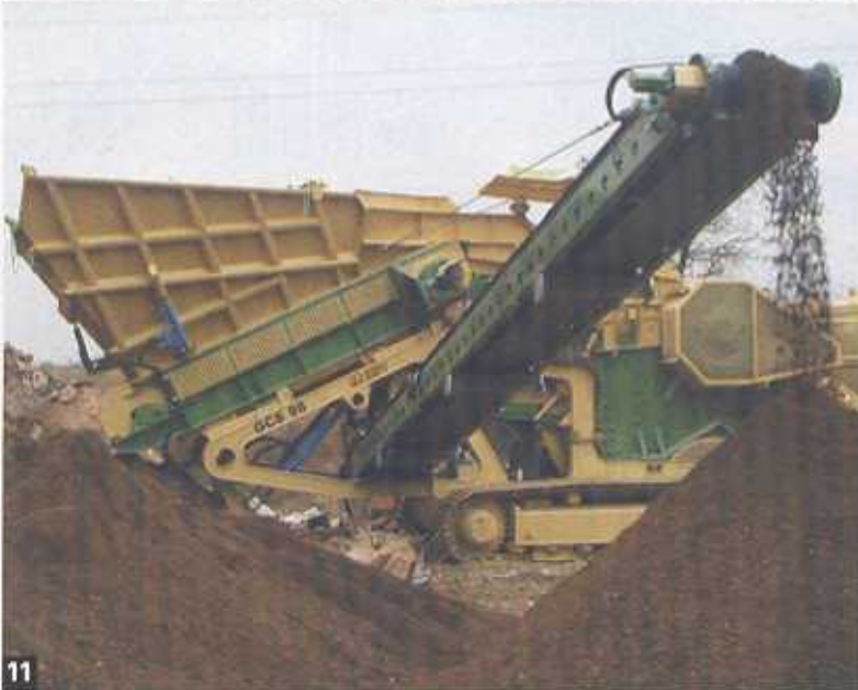
figura 10 Il nastro brandeggiante permette di realizzare un cumulo di grande volume senza l'ausilio costante della pala gommata figura 11 La macchina da demolizione a riposo
