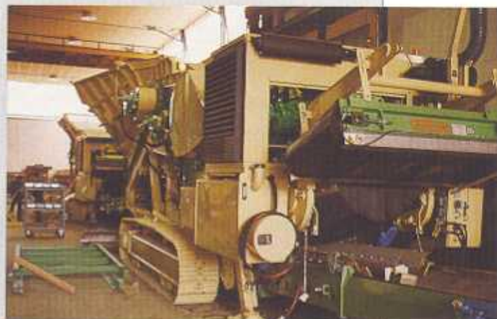
Un sistema di frantumazione semovente in fase di allestimento in REV.
