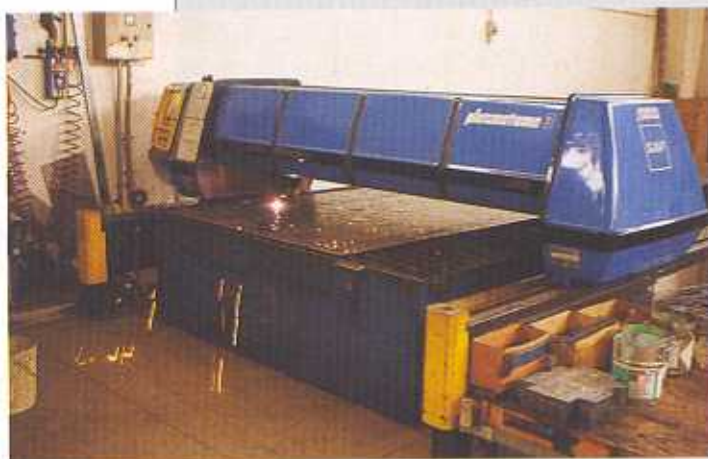
Il primo dei due sistemi di taglio plasma installati presso REV.
