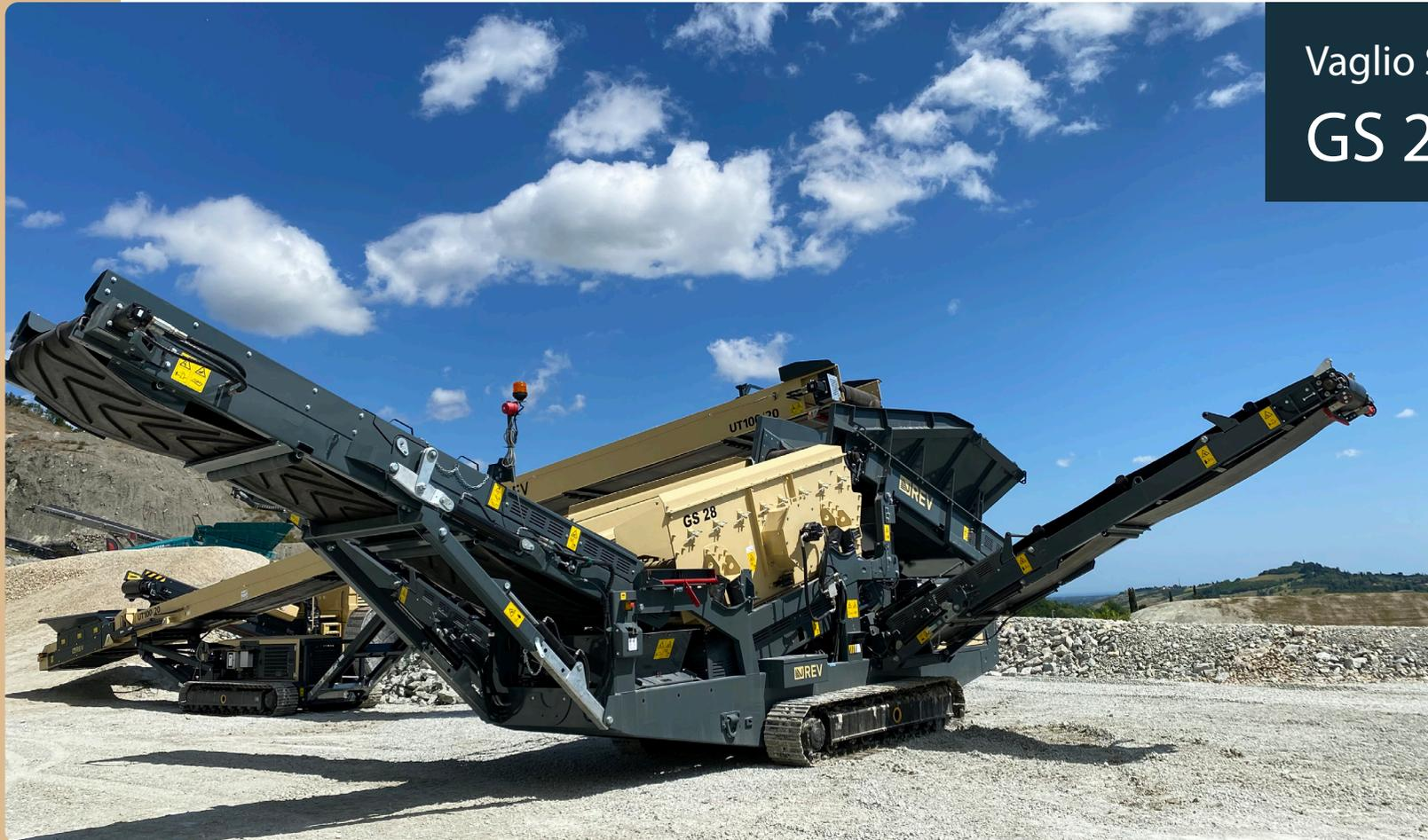
Vaglio versatile sia per impieghi gravosi che per la calibratura di prodotti fini adatto al riciclaggio, materiali inerti, terre e rocce da scavo e minerali metallici.
